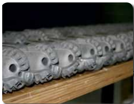
Body prêt à être brasé Body ready for brazing
